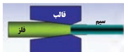
شکل ۲۵-۵- تولید سیم به روش کشش
