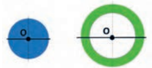
شکل ۴-۳۲- ممان اینرسی قطبی برای دو سطح مقطع متفاوت
