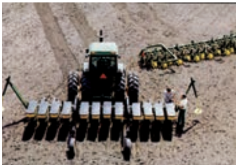
شکل ۱-۳- ظرفیت ماشین بیانگر مساحت کار شده در مدت یک ساعت می‌باشد.
