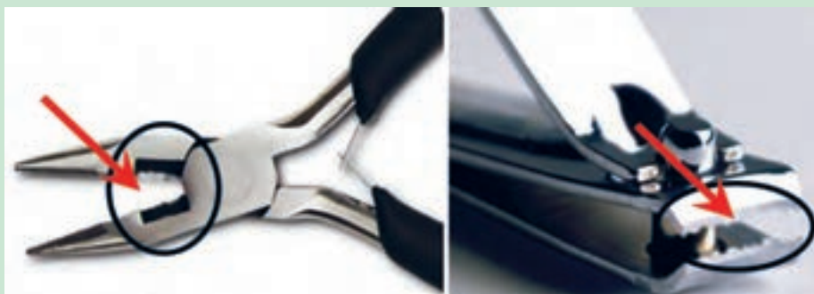
شکل ۱۹-۴- لبه‌های برنده خراب شده در ناخن‌گیر و دم‌باریک
