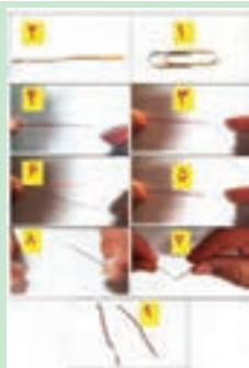
شکل ۱۳-۴ آزمایش بارگذاری روی یک مفتول گیره کاغذ
