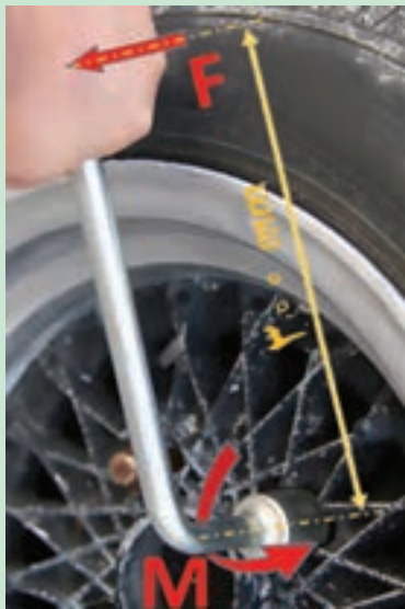
شکل ۱۱-۴ باز کردن پیچ چرخ خودرو توسط آچار چرخ
