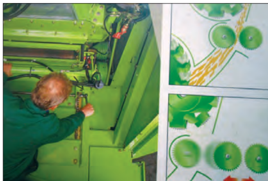
شکل ۲۱- خارج کردن بلال خردکن از مدار
