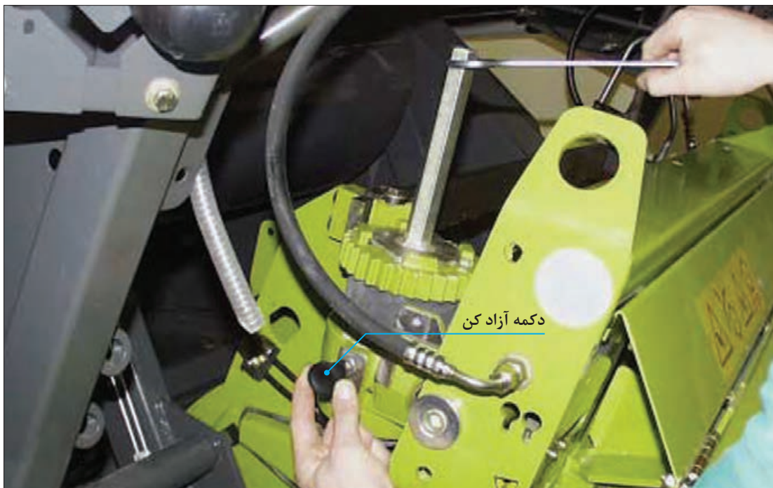
شکل ۶۴- کنترل دستی حرکت عمودی سنگ سنباده در چاپر خودگردان
