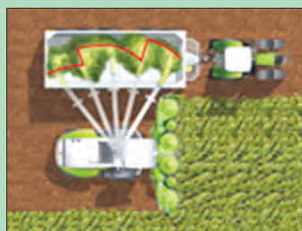
شکل ۶۰- کنترل اتوماتیک لوله تخلیه در چا پرهای جدید
