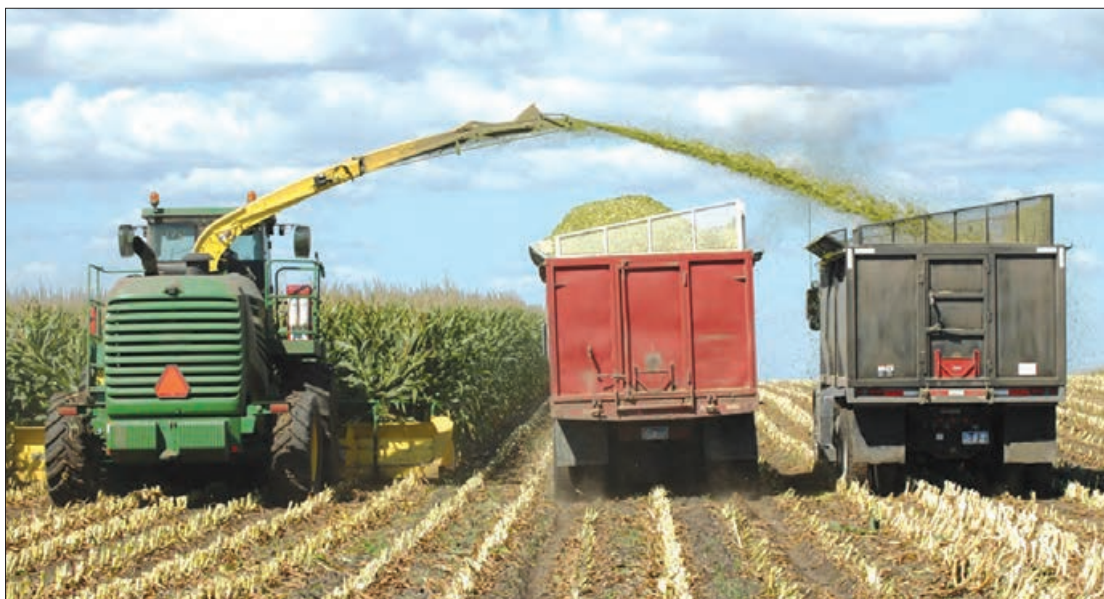
شکل ۶- برداشت ذرت به وسیله چاپر خودگردان
