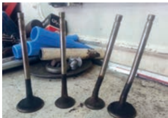
شکل ۶۷. کربن گرفتگی سرسیلندر و سوپاپ‌ها
