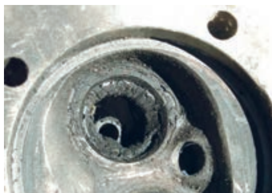
شکل ۶۷. کربن گرفتگی سرسیلندر و سوپاپ‌ها
