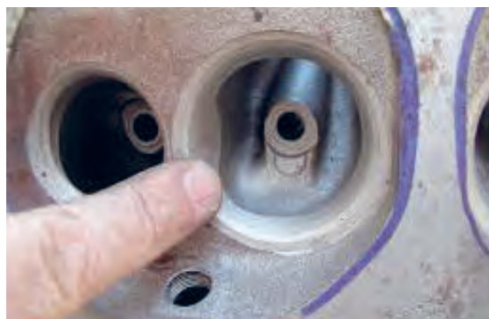
شکل ۱۵. سیت سوپاپ و زوایای لبه سوپاپ در محل نشست بر روی سیت
