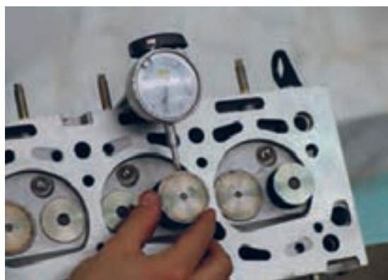
شکل ۷۳. روش کنترل لقی بین سوپاپ و گیت
