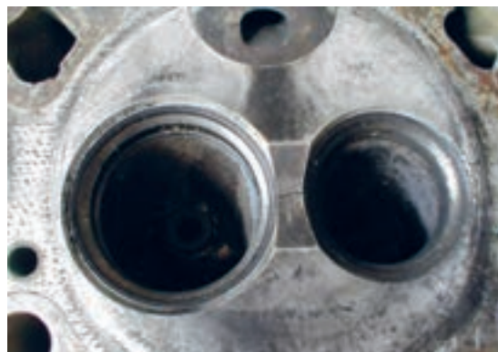
شکل ۶۶. ترک خوردگی سرسیلندر در محفظه احتراق
