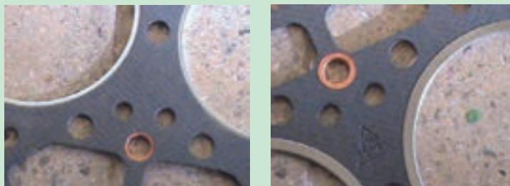
شکل ۸۷. تفاوت ضخامت قسمت‌های مسی روی واشر سرسیلندر
