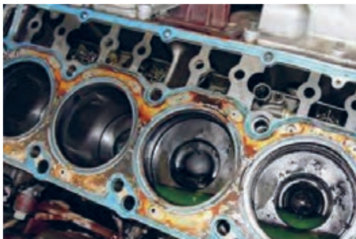
شکل ۳۰. نفوذ آب به داخل محفظه احتراق در اثر سوختن واشر سر سیلندر
