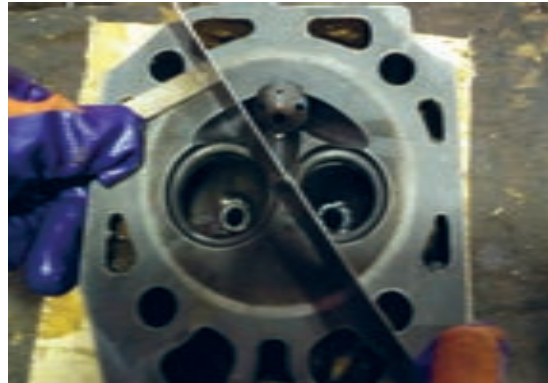
شکل ۶۵. کنترل تابیدگی سرسیلندر تراکتور دوچرخ
