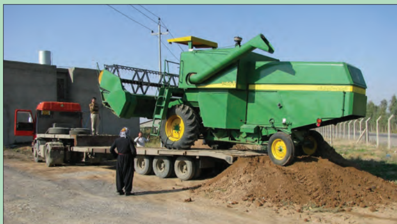
شکل ۳۵- نحوه قرار گرفتن کمباین روی یدک کش
