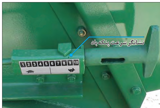
شکل ۴۴- اهرم تنظیم سرعت پنکه
