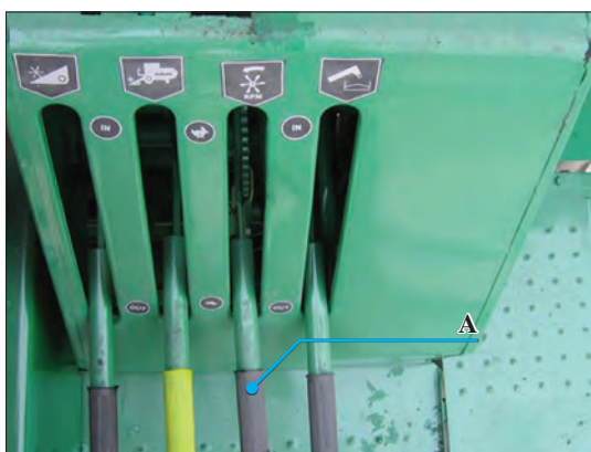
شکل ۳۹- اهرم تنظیم سرعت پروانه چرخ و فلک
