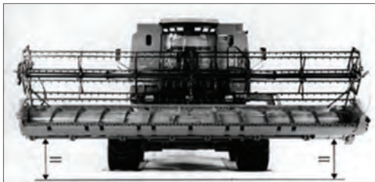
شکل ۳۷- اندازه‌گیری تراز بودن پلاتفرم
