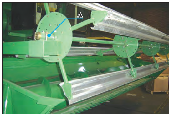
شکل ۴۰- تنظیم موقعیت پروانه چرخ و فلک
