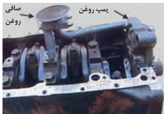
شکل ۴۱. پمپ روغن موتور و صافی آن
