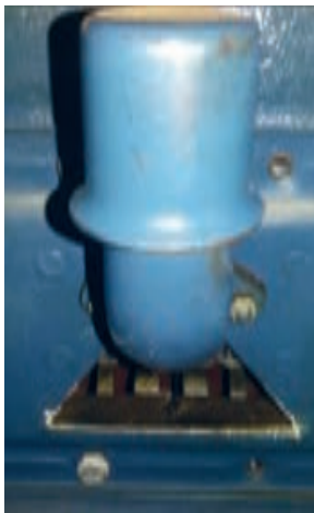
۴۰. تهویه محفظه کارتور در تراکتور U650
