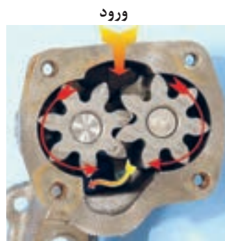
شکل ۴۲. پمپ روغن دنده ای
