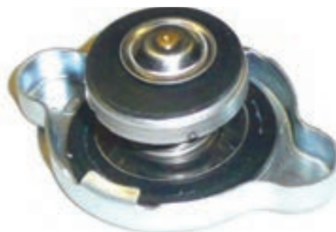
شکل ۱۲. درب رادیاتور و سوپاپ های آن
