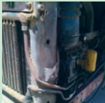
شکل ۱۳. رادیاتور روغن تراکتور U650
