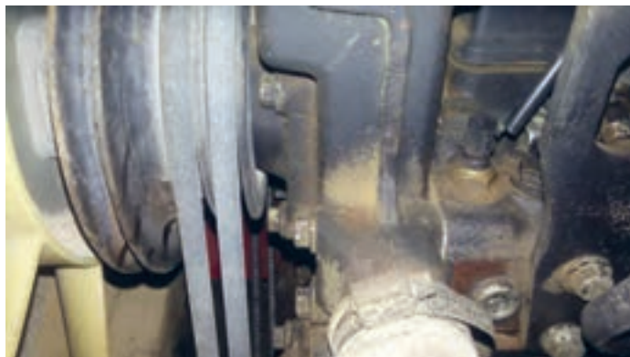
شکل ۱۰. محل فشنگی آب روی تراکتور MF۳۹۹
