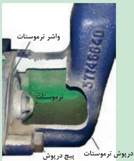
شکل ۱۷. نمای برش خورده ترموستات تراکتور MF۲۸۵
