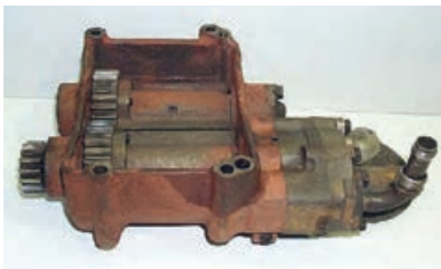
شکل ۴۴. بالانسره های نصب شده روی پمپ روغن
