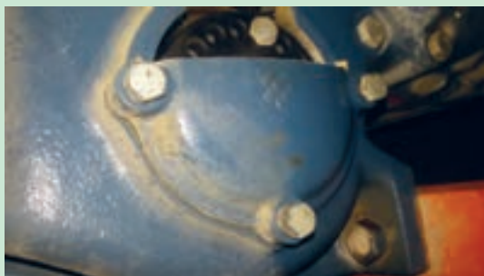
شکل ۳۳. تصویر برش خورده از درپوش زمان بندی و فلانچ پمپ انژکتور تراکتور U650M
