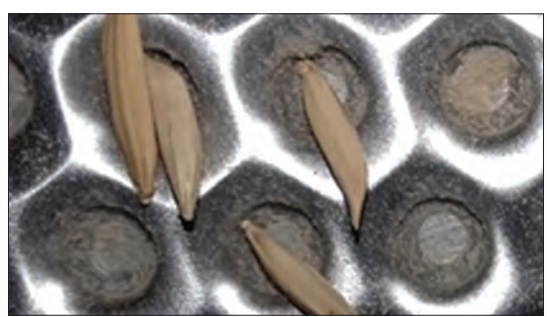
شکل ۱۶- قرار گرفتن دانه‌ها در سوراخ‌های استوانه حفره‌دار
