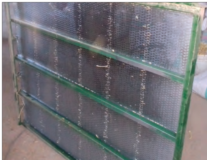
شکل ۳۹- قرار دادن غربال به صورت آویزان
