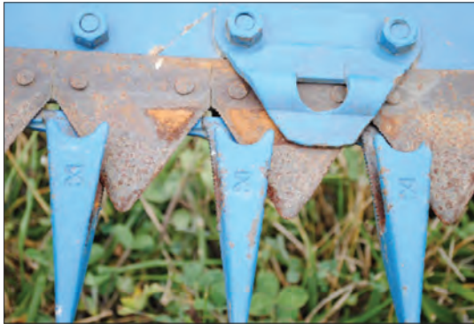
شکل ۱۰- موقعیت انگشتی و تیغه در دروگر شانه‌ای
