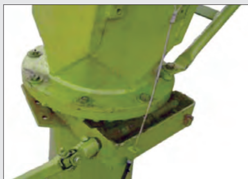
شکل ۴۰- چرخ دنده دوران لوله
