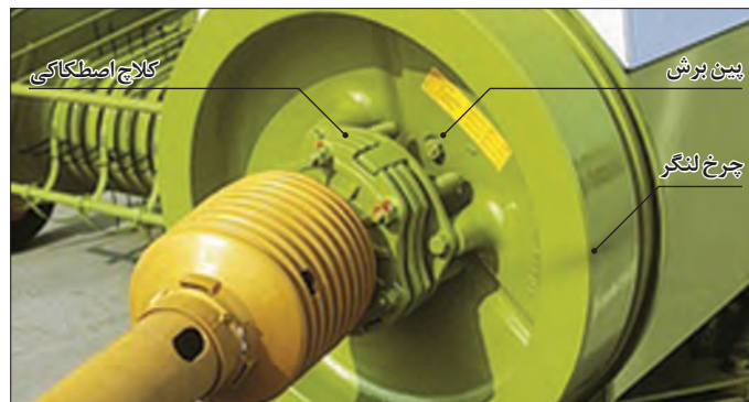
شکل ۸۰- چرخ لنگر و کلاچ ایمنی
