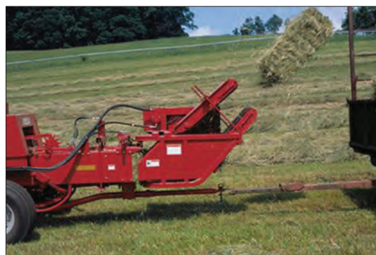
ب) بسته‌بند مجهز به بسته پرتاب کن
