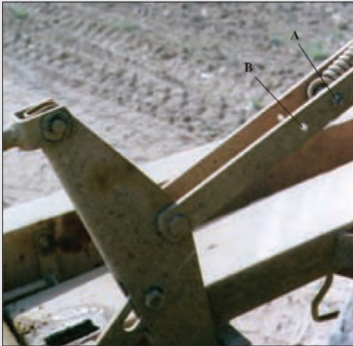
شکل ۳۷- تنظیم فنر شناور
