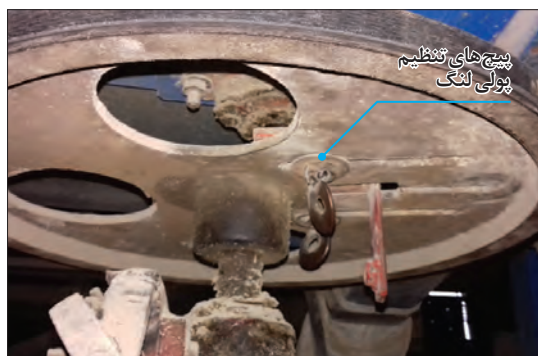
شکل ۳۴- پیچ تنظیم کورس غربال کابلی
