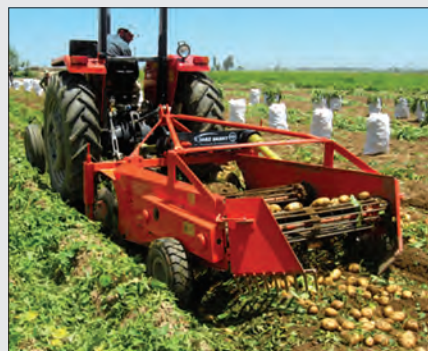
شکل ۱۷- برداشت سیب‌زمینی با سیب‌زمینی‌کن نقاله‌ای
