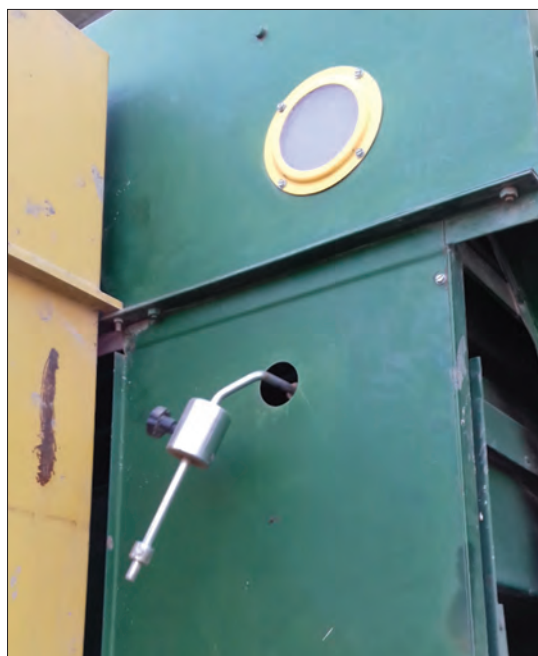
شکل ۳۳- وزنه تنظیم ضربه زن غربال بالایی
