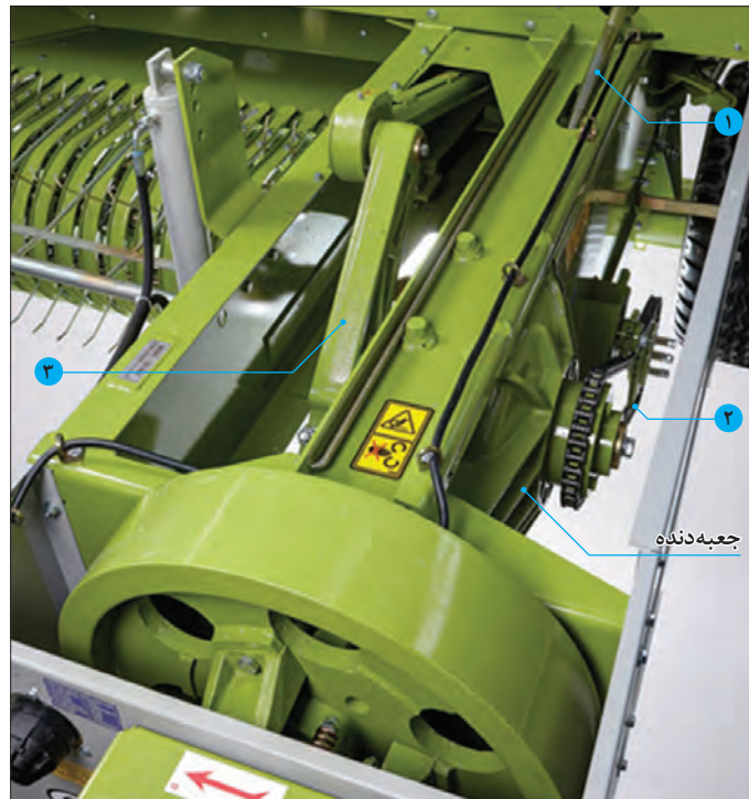
شکل ۸۲- مسیر انتقال توان در بسته‌بند
