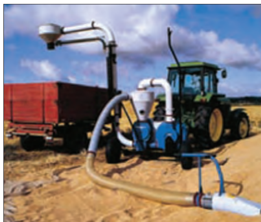
شکل ۲۹- نقاله بادی و طرز کار آن
