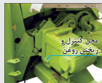
شکل ۴۵- جعبه دنده باردهی غلتک‌های تغذیه
