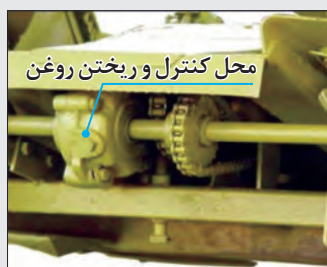
شکل ۴۷- جعبه دنده دوکفه ای
