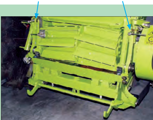
شکل ۲۸- اهرم‌های تنظیم تیغه ثابت در چاپر خودگردان
