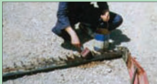
شکل ۵۰- تمیز کردن شانه برش با گازوئیل
