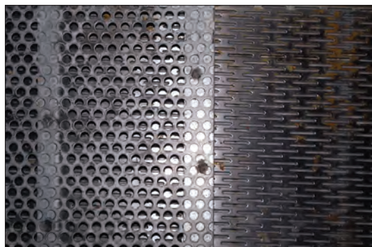
شکل ۳۱- دو نمونه غربال با سوراخ‌های متفاوت
