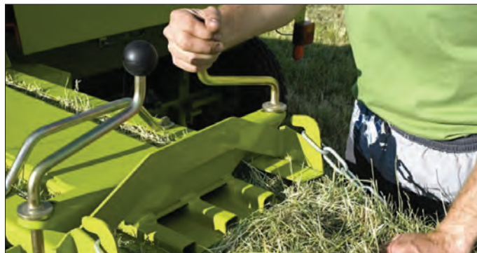
شکل ۱۰۱- تیرک‌های فشاردهنده و تنظیم آن
