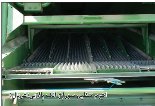
شکل ۲۴- الک بالایی تمیز کننده
