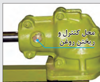
شکل ۴۶- جعبه دنده زانویی تیغه درو
