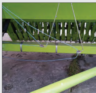
شکل ۹۱- مسیر نخ کردن بسته‌بند و جایگاه سوزن
