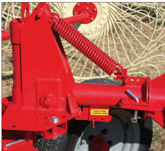
شکل ۶۰- فنرهای شناوری شانه خورشیدی
