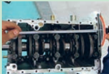
شکل ۴۶. باز کردن پیچ های یاتاقان
