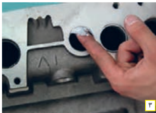
شکل ۶۹. روش تعویض پولک سر سیلندر
