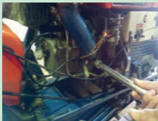
شکل ۵۲. باز کردن مانیفولد هوا
