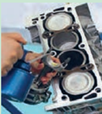
شکل ۱۰۱. روغن کاری کپه یاتاقان شاتون
