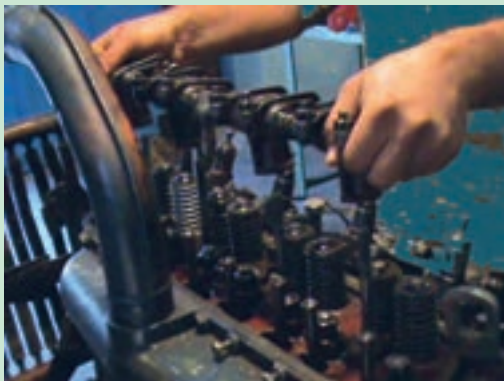
شکل ۴۶. برداشتن مجموعه اسبک از روی سرسیلندر
