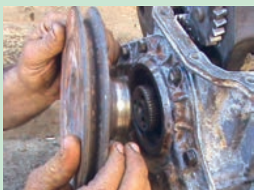
شکل ۱۱۲. جا زدن پولی سر میل لنگ
