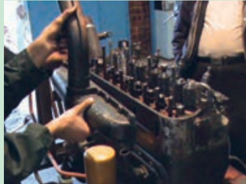
شکل ۴۳. باز کردن مانیفولد تراکتور U650
