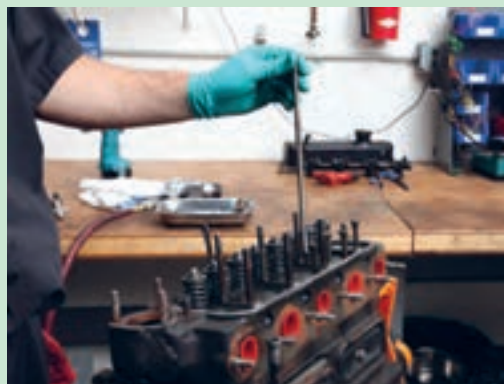
شکل ۴۷. خارج کردن میل تپت‌ها
