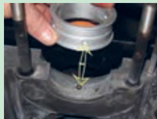
شکل ۹۳. قرار گرفتن سوراخ روغن مقابل هم
