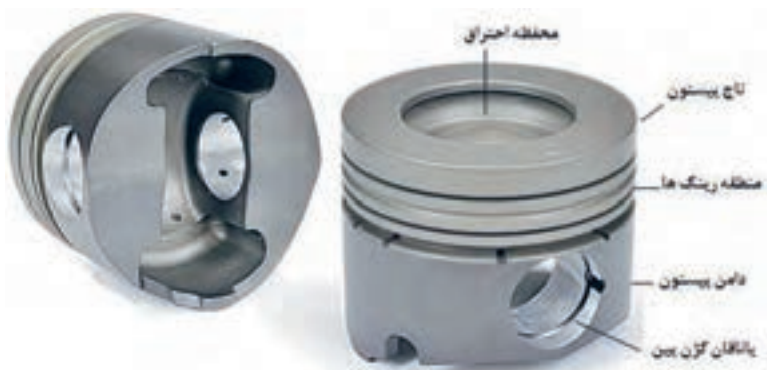
شکل ۶. پیستون و قسمت‌های مختلف آن
