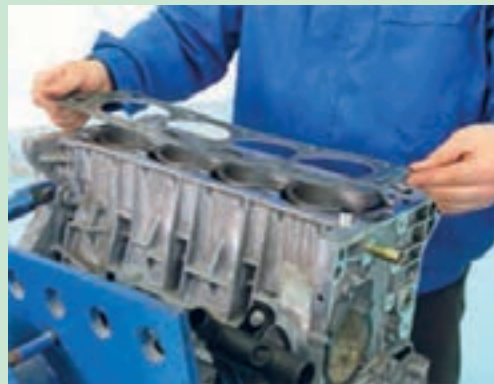
شکل ۵۰. برداشتن و اثر سر سیلندر
