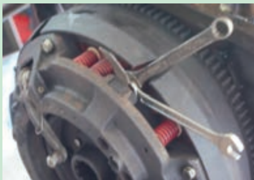
شکل ۳۹. تنظیم کلاچ محور تواندهی
