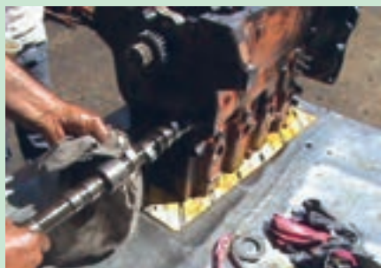
ب- خارج کردن میل سوپاپ
