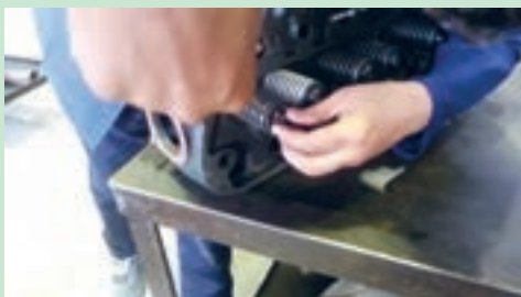
شکل ۵۷. خارج کردن لاستیک آببندی سوپاپ
