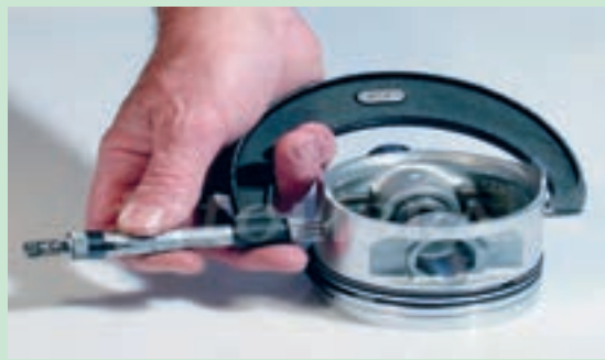
شکل ۷۵. اندازه‌گیری قطر پیستون با میکرو متر
