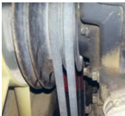
شکل ۷. استفاده از دو تسمه در تراکتور MF399
