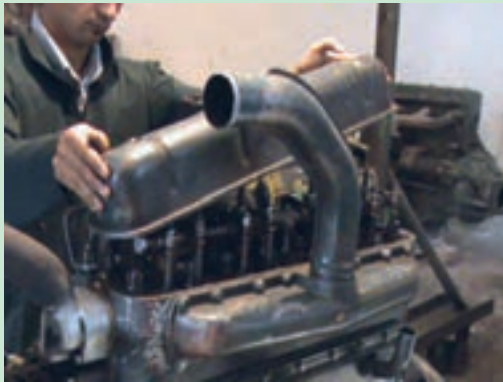
شکل ۴۴. برداشتن درپوش سوپاپ‌های تراکتور U650
