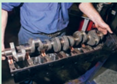
شکل ۴۹. برداشتن میل لنگ
