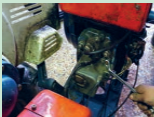
شکل ۵۳. باز کردن درپوش سوپاپ‌ها
