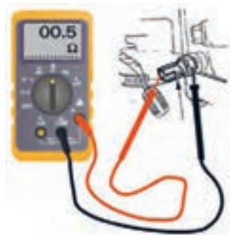
شکل ۴۹. کنترل فشنگی روغن
