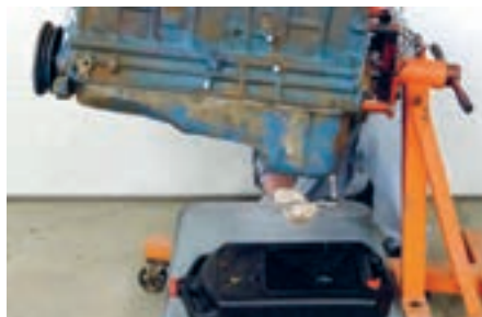
شکل ۳۳. موتور نصب شده روی استند
