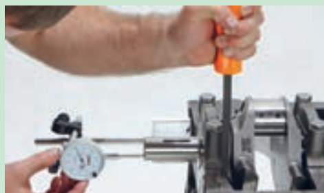
شکل ۸۸. اندازه گیری لقی طولی میل لنگ با ساعت اندازه گیر و فیلر تیغه ای
