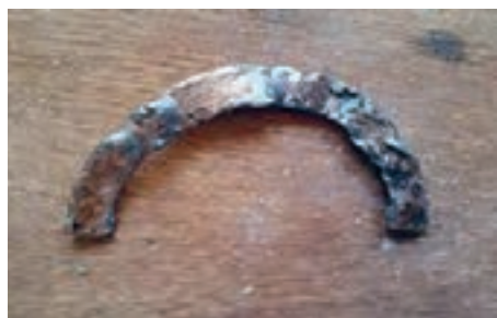
شکل ۷۳. نمونه بغل یاتاقانی معیوب
