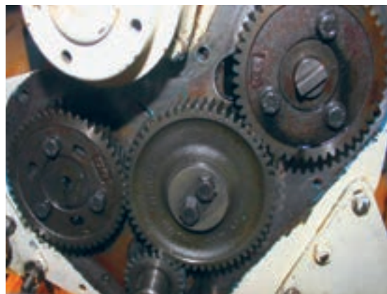
شکل ۲۷. چرخ دنده های تایمینگ در سینی جلو موتور
