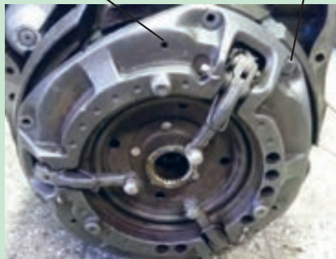
شکل ۲۵. جدا کردن مجموعه کلاچ از فلاپویل
