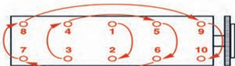
شکل ۳۹. بستن پیچ‌های سر سیلندر به روش حلزونی
