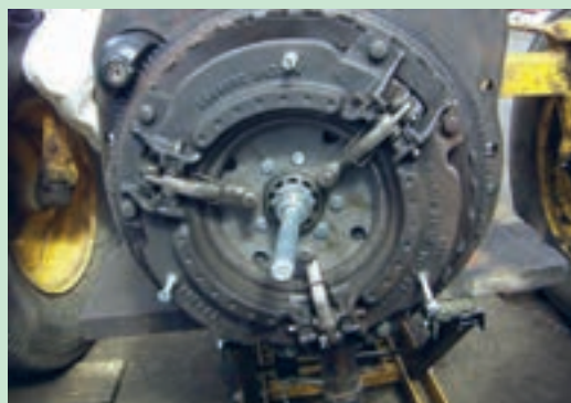
شکل ۳۷. سوار کردن مجموعه کلاچ روی فلاپیول
