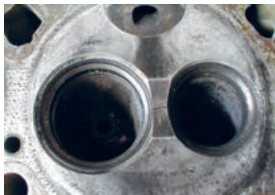
شکل ۶۶. ترک خوردگی سرسیلندر در محفظه احتراق
