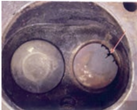
شکل ۷۰. عیوب ظاهری سوپاپ‌ها
