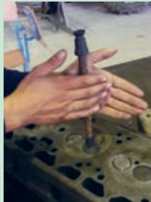
شکل ۷۹. چرخاندن سوپاپ به وسیله چوب سوپاپ گردان
