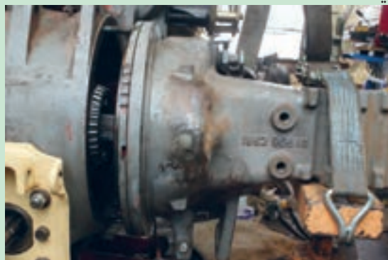
شکل ۷. باز کردن پوسته قیفی تراکتور MF285
