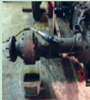
شکل ۳۲. کاهنده نهایی بعد از باز کردن چرخ
