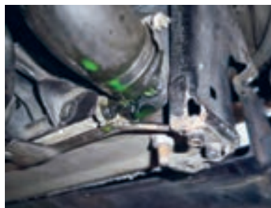
شکل ۵. نشتی از محل اتصالات
