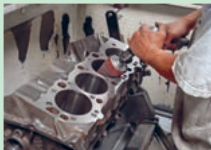
شکل ۳۹. ترمیم لبه بالای سیلندر
