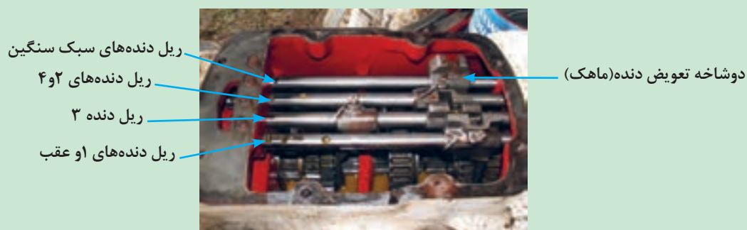
شکل ۳۰. جعبه دنده تراکتور MF285
