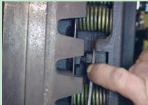
شکل ۳۹. تنظیم کلاچ محور تواندهی
