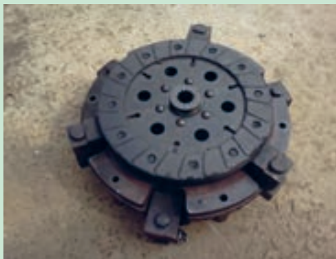
شکل ۲۵. جدا کردن مجموعه کلاچ از فلاپویل
