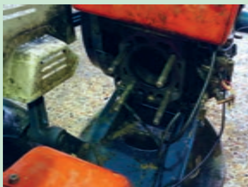
شکل ۵۶. برداشتن سر سیلندر
