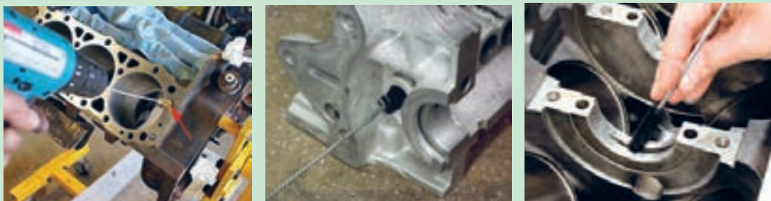
شکل ۵۹. تمیز کردن مجاری آب و روغن
