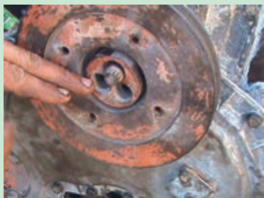
شکل ۱۱۳. پیچ های پولی سر میل لنگ
