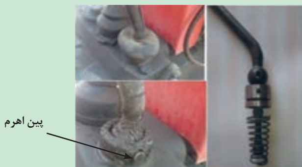
شکل ۲۹. خارج کردن اهرم‌های تعویض دنده
