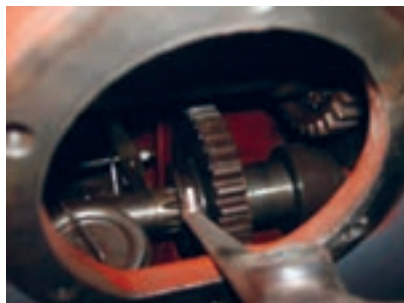
شکل ۲۱. محور تواندهی در حالت موتور گرد
