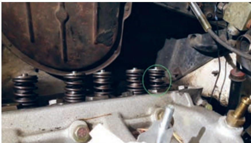
شکل ۷۱. شکستن فنر سوپاپ
