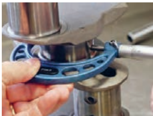
شکل ۷۱. اندازه‌گیری قطر میل‌لنگ
