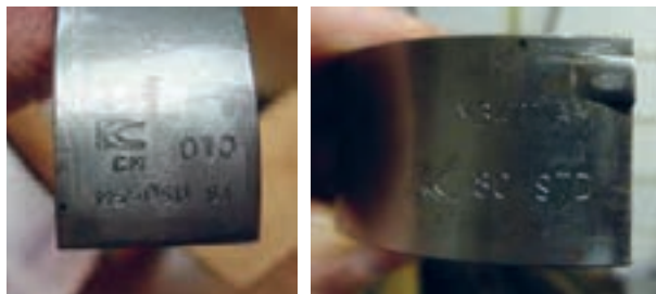
شکل ۲۳. تغییر ضخامت یاتاقان در سایزهای مختلف
