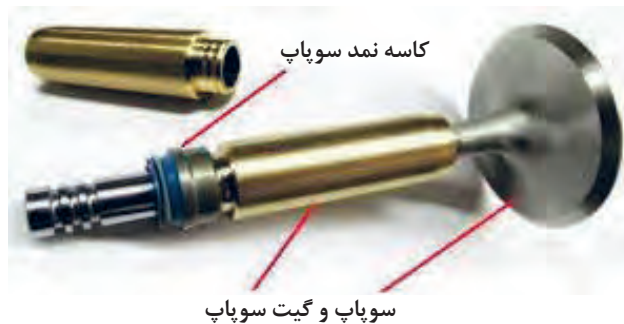
شکل ۲۸. فرسودگی گیت یا کاسه نمد سوپاپ منجر به روغن سوزی می‌شود.
