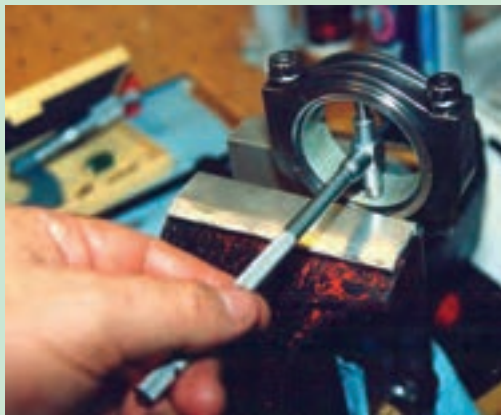
شکل ۸۳. کنترل بیضی شدن سر بزرگ شاتون
