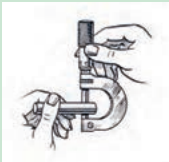
شکل ۸۱. اندازه گیری لقی گزن بین در پیستون
