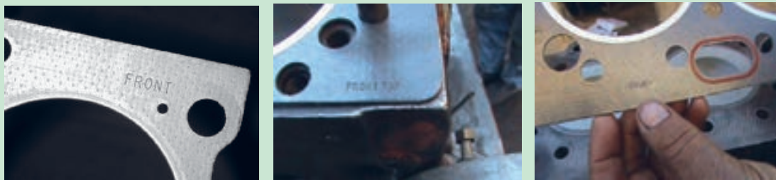
شکل ۸۶. علامت‌های روی واشر سرسیلندر
