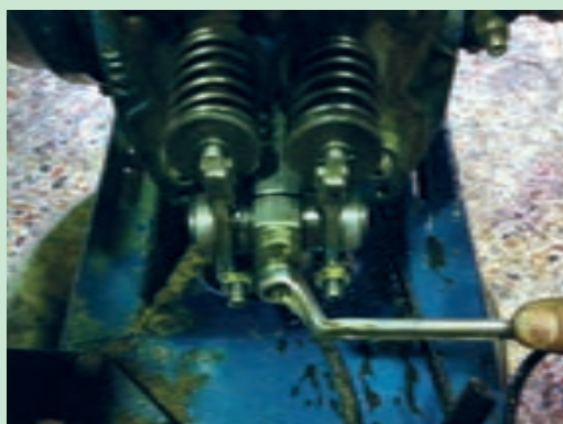
شکل ۵۴. باز کردن مجموعه اسبک‌ها
