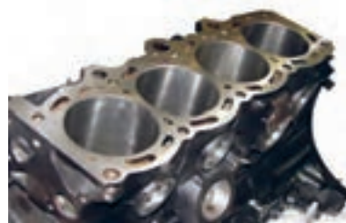
الف- سیلندر یکپارچه با بلوک سیلندر
