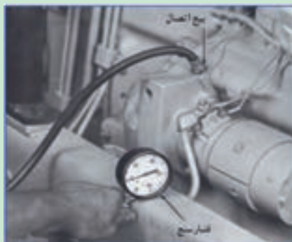
شکل ۵°. فشار سنجی مدار روغن کاری
