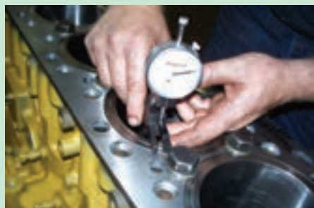
شکل ۹۱. اندازه‌گیری بیرون زدگی بوش در سطح بلوکه سیلندر
