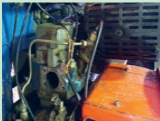
شکل ۵۲. باز کردن مانیفولد هوا
