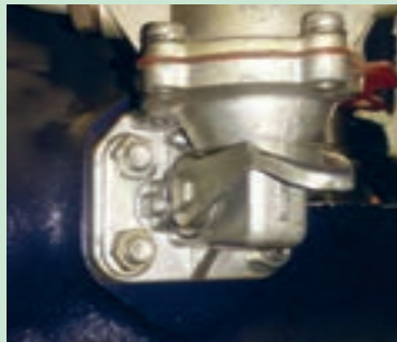
شکل ۳۶. پیچ و مهره اتصال پمپ مقدماتی تراکتور MF285 به بدنه تراکتور
