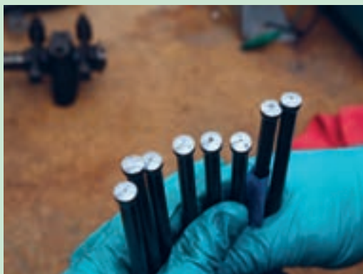
شکل ۴۷. خارج کردن میل تپت‌ها
