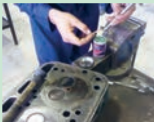
شکل ۷۸. زدن روغن سنباده به سوپاپ‌ها
