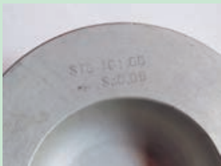
شکل ۹۹. وارد کردن پیستون به داخل سیلندر شکل ۱۰۰. علامت روی پیستون
