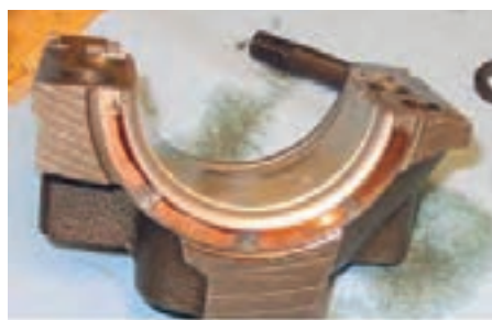
شکل ۷۳. نمونه بغل یاتاقانی معیوب
