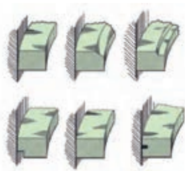
شکل ۱۱. انواع پخ رینگ کمپرسی
