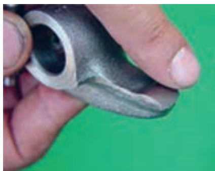
شکل ۷۵. فرسودگی سر اسبک
