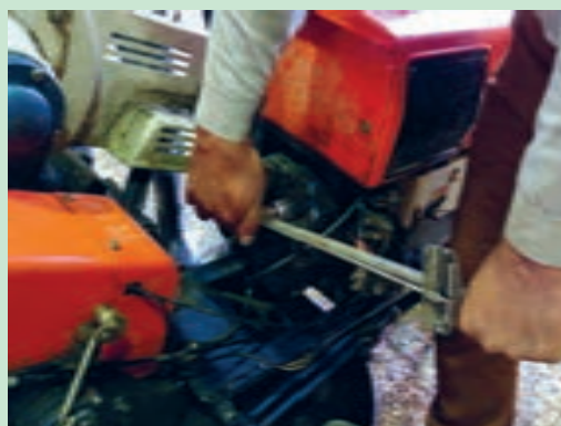
شکل ۵۵. باز کردن سر سیلندر
