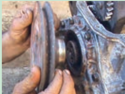
شکل ۳۵. پیاده کردن پولی میل لنگ
