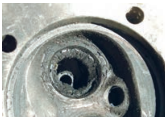
شکل ۶۷. کربن گرفتگی سرسیلندر و سوپاپ‌ها
