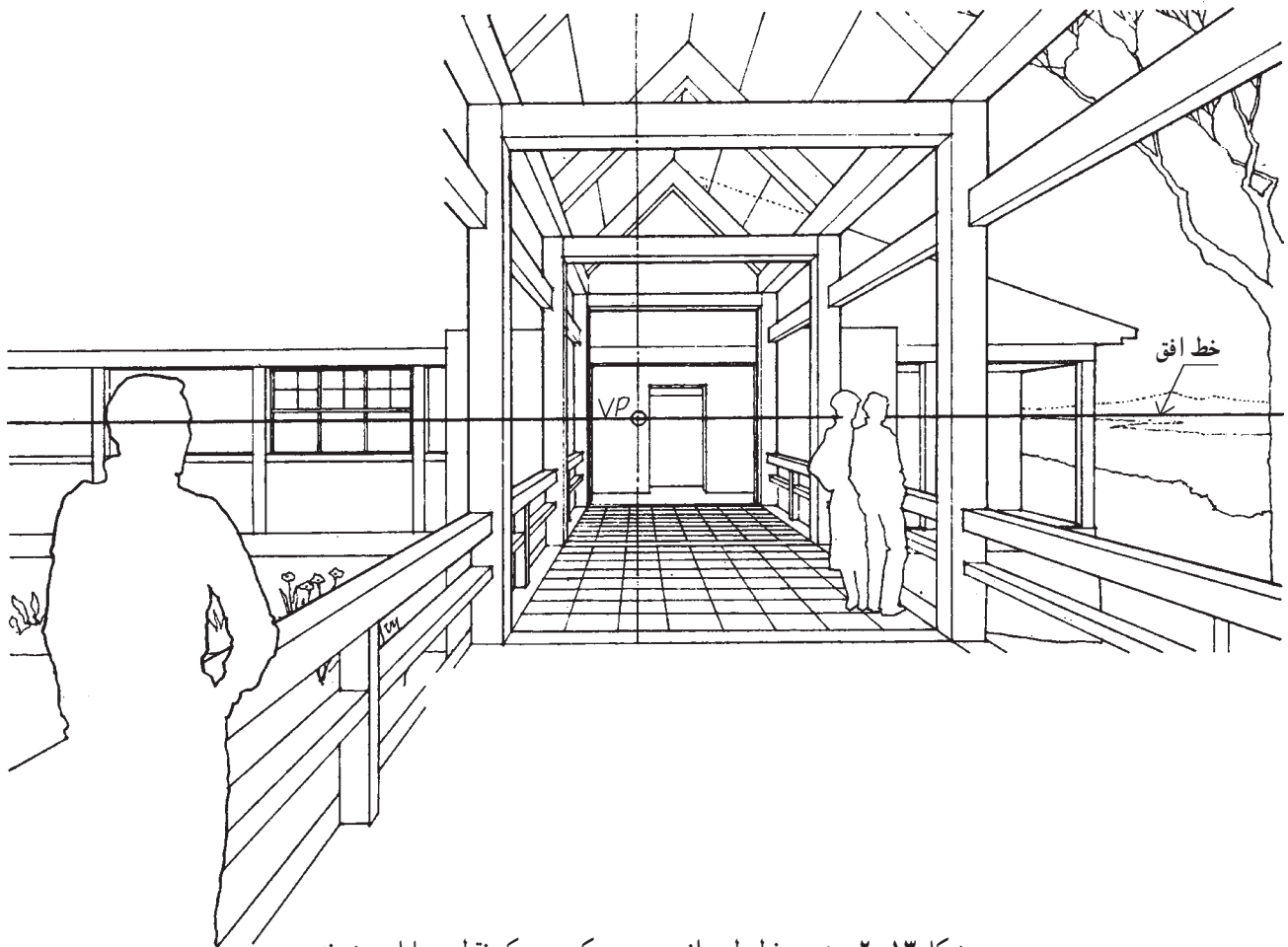
شکل ۱۳-۲- هم‌ی خطوط موازی در پرسپکتیو به یک نقطه متمایل می‌شوند.
