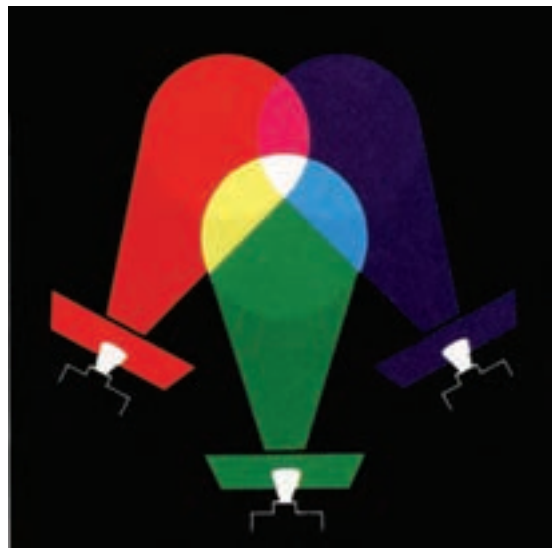
شکل ۵-۷- وقتی سه منبع نور بنفش، سبز و قرمز با یکدیگر تلاقی کنند، در محل تلاقی آن‌ها روی صفحه سفید از طریق ترکیب افزایشی نور سفید حاصل می‌شود. زیرا هر سه طیف کوتاه، متوسط و بلند نور را در خود دارند.
