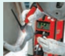
جوشکاری با پلاسما
