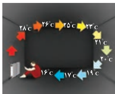
شکل ۴-۲۸ گرم شدن هوای اتاق به روش همرفت
