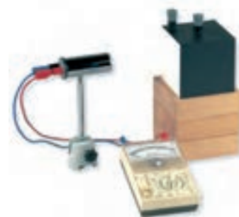
شکل ۴-۳۳ درون مکعب لسلی، آب داغ می‌ریزند. تابش گرمایی از چهار وجه مکعب که رنگ‌های متفاوتی دارند، با هم فرق دارد.
