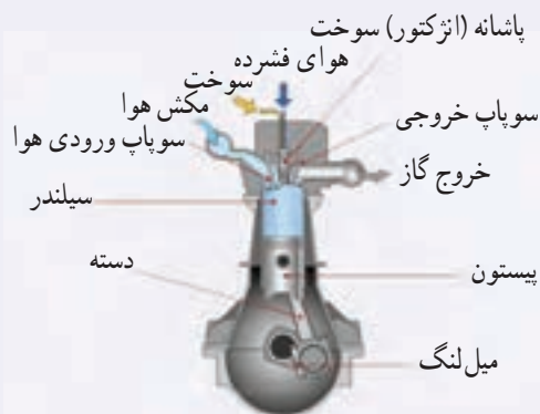
شکل ۵-۲۰ طرحی از اجزای یک ماشین دیزل
