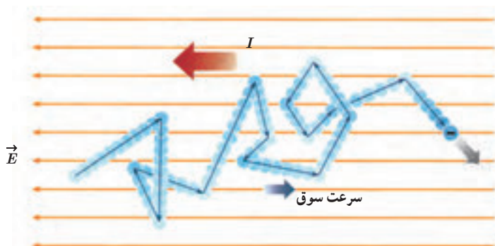
شکل ۲-۷ مسیر زیگزاگ یک الکترون آزاد در یک رسانای فلزی. در حضور میدان الکتریکی، این مسیر زیگزاگ در خلاف جهت میدان سوق یافته است.
