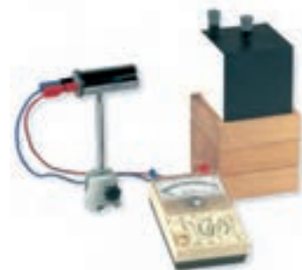
شکل ۱۴-۳۳ درون مکعب لسلی، آب داغ می‌ریزند. تابش گرمایی از چهار وجه مکعب که رنگ‌های متفاوتی دارند، با هم فرق دارد.
