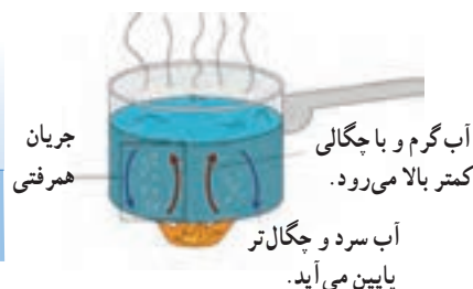
شکل ۴-۲۹ گرم شدن آب درون قابلمه به روش همرفت
