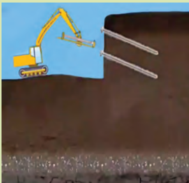
پایدارسازی شیب به روش میخ کوبی
