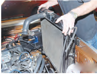
شکل ۱۱- سامانه خنک کننده خودرو از گرم شدن بیش از حد موتور جلوگیری می‌کند.
