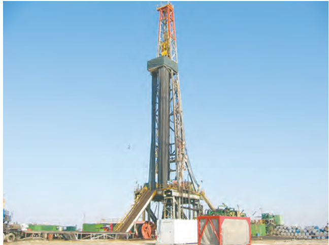
شکل ۱۰- دکل حفاری چاه‌های اکتشافی نفت و گاز
