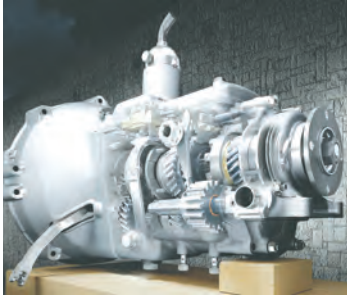
شکل ۱۵ - ترکیب پیچیده‌ای از چرخ‌دنده در جعبه‌دنده خودرو
