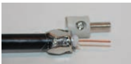
۶- مفتول مسی کابل را به اندازه طول سوزنی روکش برداری کنید.
