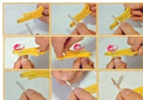
شکل ۷ - روکش برداری کابل
