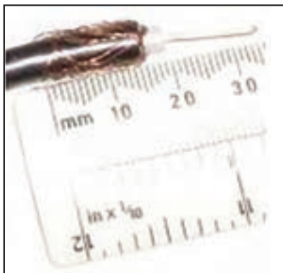
۴- عایق زیر را نیز روکش برداری کنید.
