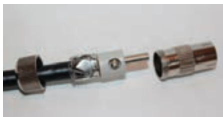
۷- سوزنی را در محل خود قرار داده تا انتها فشار دهید و پیچ آن را محکم ببندید.
