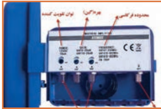
شکل ۱۵- مشخصات فنی یک بوستر یا تقویت کننده
