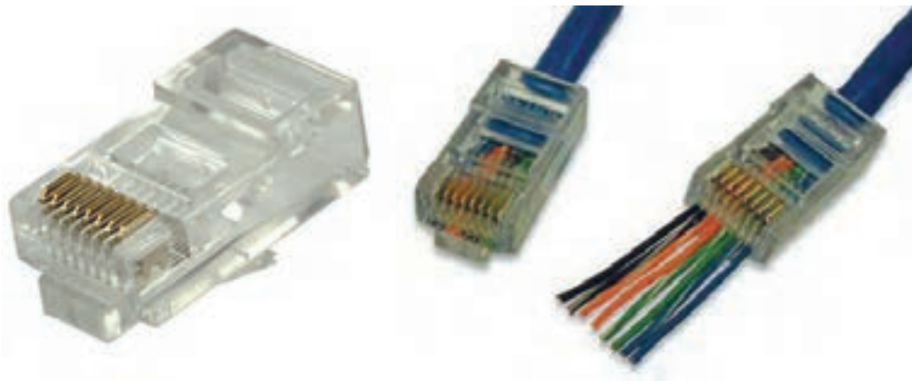
شکل ۸ - فیش شبکه رایانه RJ ۴۵
