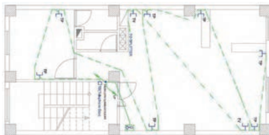
شکل ۱۰ - نقشه سیم‌کشی پریز تلفن و پریز آنتن
