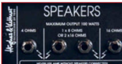
شکل ۲۰- امپدانس خروجی بلندگو
