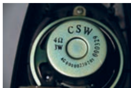
شکل ۹- توان بلندگو و امپدانس
