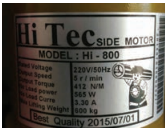
شکل ۱۲- موتور در کرک‌های از نوع سایید با ولتاژ ۲۲ ولت برای در ۶۰۰ کیلوگرمی
