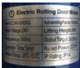
شکل ۱۰- پلاک موتور در خودکار
