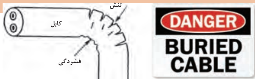
شکل ۲۳- تنش فشردگی خمش کابل
