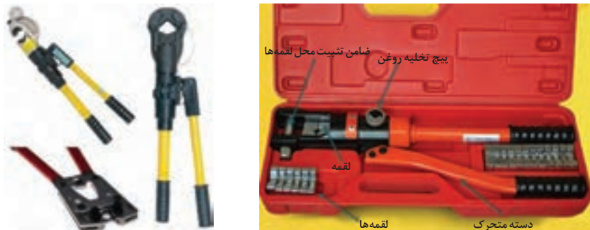
شکل ۱۵- کابلشو هیدرولیکی و دستی
