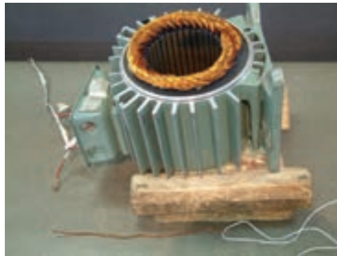
شکل ۳۹- جا زدن سیم پیچ
