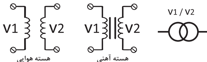
شکل ۳- علائم اختصاری ترانسفورماتور با هسته های مختلف
