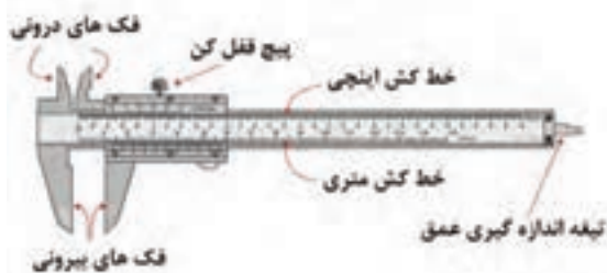
شکل ۹- اجزای تشکیل دهنده کولیس
