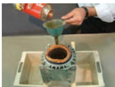
شکل ۶۰- شارلاک زدن سیم پیچی استاتور
