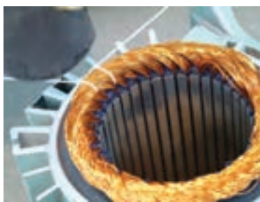
شکل ۵۸- نخ بندی سیم پیچی موتور
