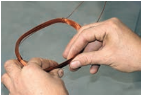
شکل ۳۸-۲ مرتب کردن سیم‌ها جهت کلاف گذاری
