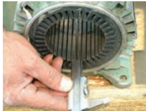
شکل ۲۷- اندازه گیری طول و قطر داخلی استاتور
