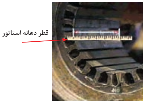
شکل ۲۷- اندازه گیری طول و قطر داخلی استاتور
