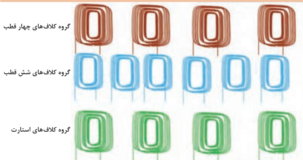
شکل ۴۷- تهیه گروه کلاف های سیم پیچی
