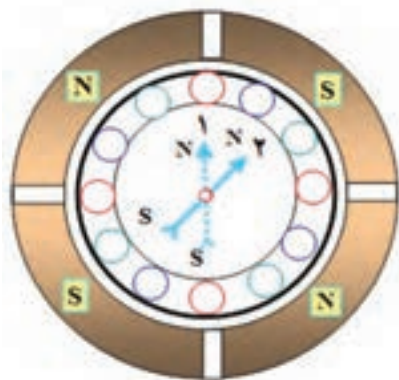
موتور چهار قطب جابه جایی الکتریکی ۹۰ درجه و جابه جایی مکانیکی ۴۵ درجه
