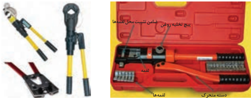
شکل ۱۵- کابلشو هیدرولیکی و دستی
