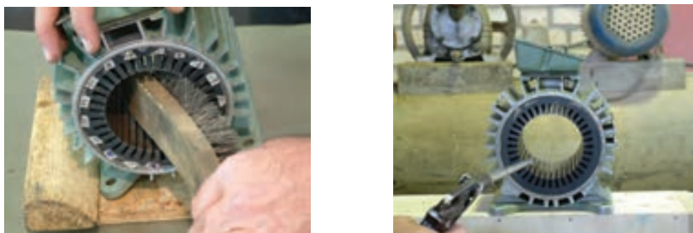
شکل ۲۵-۱ داخل شیارها را با برس تمیز کنید
