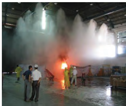
شکل ۱۱-۴- سیستم پاشش آب اطفاء حریق
