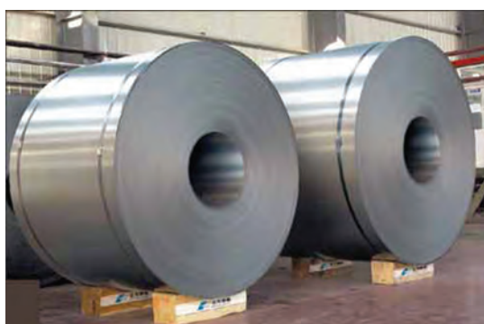
شکل ۱۱-۵- نحوه انبار کردن رول‌ها
