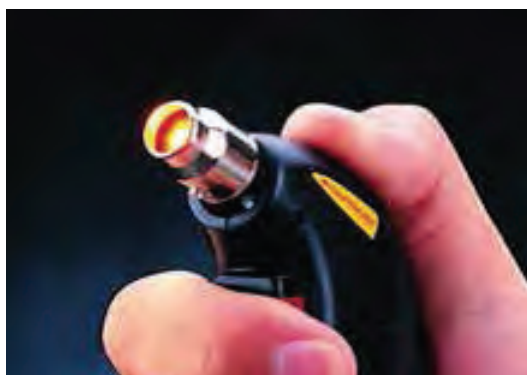
شکل ۶۱-۱ - دستگاه گرم کن برای وارنیش حرارتی
