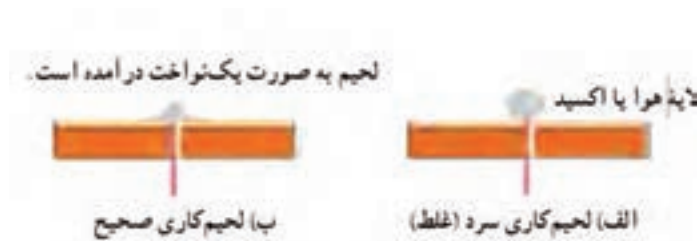
شکل ۵۰-۱- لحیم‌کاری صحیح و غلط
