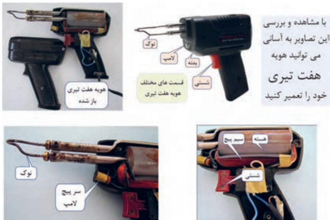
شکل ۹۶-۱ - چگونگی باز کردن هویه هفت تیری و اجزاء آن
