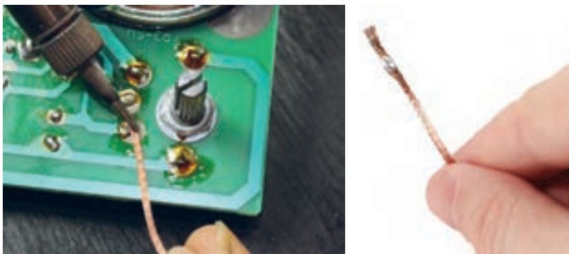
شکل ۸۰-۱- برداشتن قلع از روی فیبر
