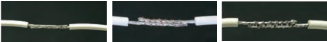
شکل ۶۰-۱- اجرای یک اتصال ساده
