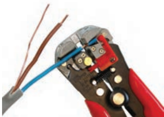
شکل ۲۱-۱- روکش‌برداری با سیم لخت کن خودکار
