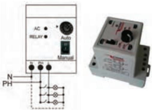
شکل ۲-۷۰- نمونه واقعی اتصال رله راه پله
