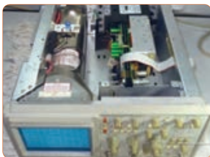
شکل ۴-۵۲- ساختمان داخلی یک نوع اسیلوسکوپ
