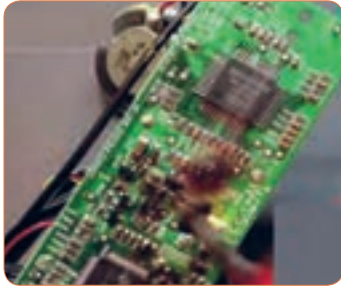
شکل ۵-۵ - قطعاتی از برد سوخته است.
