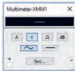
شکل ۳۷ - تنظیم مولتی‌متر برای اندازه‌گیری ولتاژ AC
