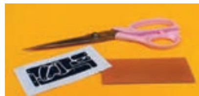
شکل ۷-۷- برش طرح مدار چاپی از کاغذ
