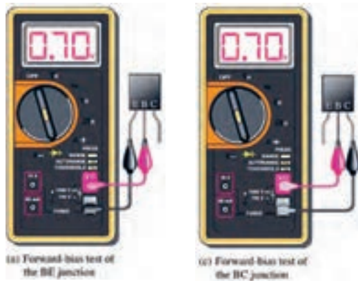
شکل ۴-۳- تشخیص پایه بیس ترانزیستور با مولتی‌متر دیجیتالی
