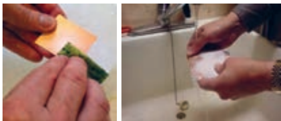
شکل ۱۹-۵- شستشو و تمیز کردن فیبر مدار چاپی
