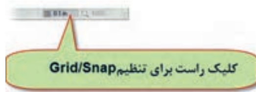
شکل ۴۱-۶- مسیر تنظیم Grid/Snap
