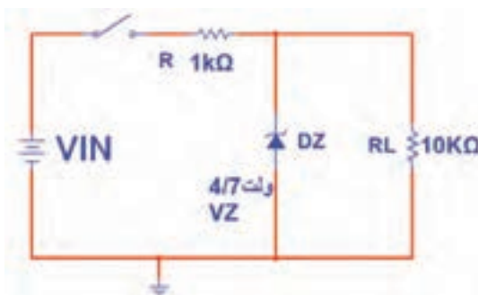
شکل ۳-۶۹- مدار آزمایش رگولاتور با زنر
