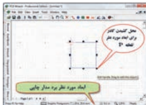
شکل ۳۸-۶- نحوه تعیین اندازه برد مدار چاپی
