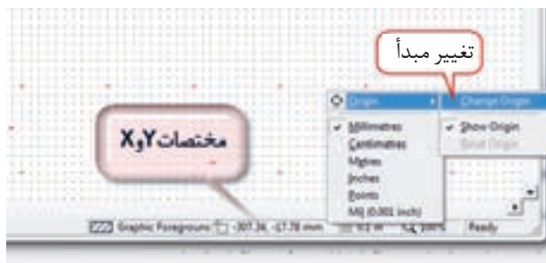
شکل ۲۸-۶- Origin و تعیین واحد مختصات X و Y
