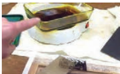
شکل ۱۵-۷- استفاده از اجاق برقی برای حرارت دادن محلول اسید کاری
