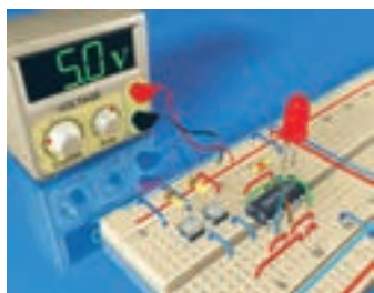
شکل ۷-۴- بستن مدار روی بردبرد و آزمایش آن
