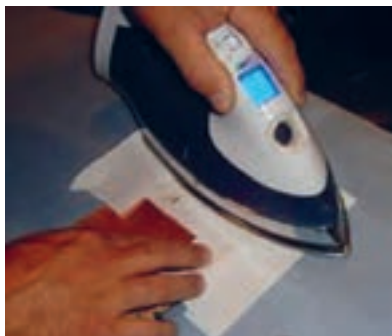
شکل ۹-۷- کشیدن اتو روی کاغذ و فیبر
