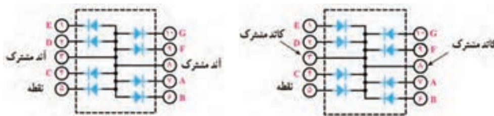
الف- مدار آند مشترک
