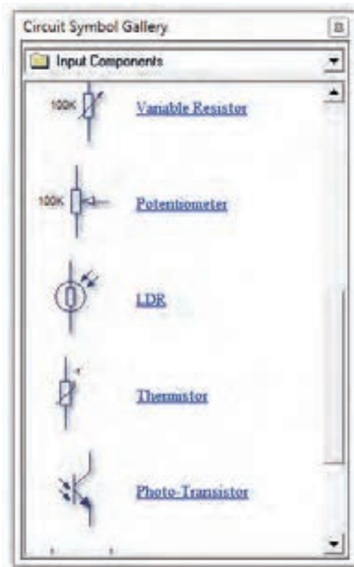
شکل ۶-۱۰- عناصر ورودی مدار
