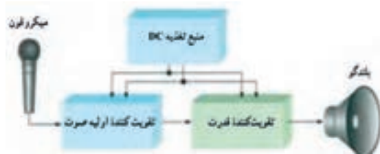
شکل ۴-۱۷- بلوک دیاگرام آمپلی فایر صوتی
