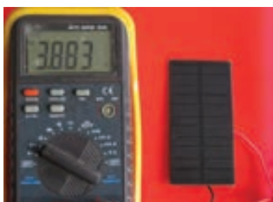
شکل ۳-۹۵- اندازه‌گیری ولتاژ سلول خورشیدی
