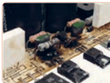
شکل ۲۴-۵ - آسیب قطعات در یک بُرد
