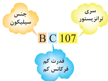
شکل ۳۱-۱۴ مشخصات ترانزیستور BC۱۰۷
