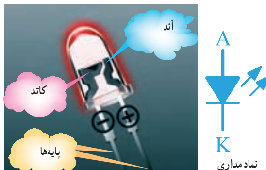
شکل ۳۰-۱۳ نماد فنی و ساختمان داخلی LED
