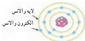
شکل ۹-۱ لایه‌ها و الکترون و الانس
