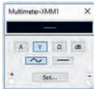
شکل ۳۷ - تنظیم مولتی‌متر برای اندازه‌گیری ولتاژ AC
