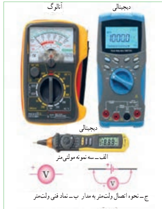
شکل ۵۵-۱- ولت متر و نماد آن
