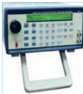
ب - سیگنال ژنراتور با کلیدها و سلکتورهای لمسی شکل ۳۳ - ۴ - دو نمونه سیگنال ژنراتور
