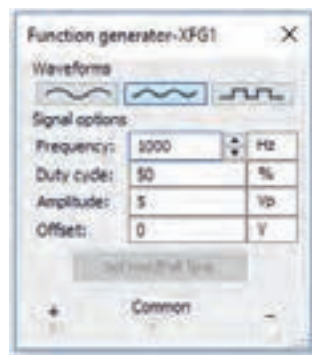
شکل ۱۶- ۴- مشخصات موج ورودی
