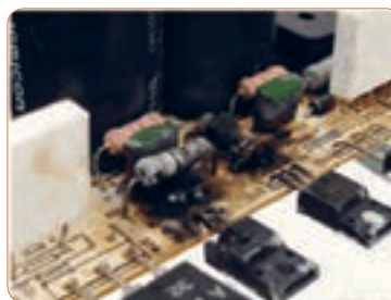
شکل ۲۴-۵ - آسیب قطعات در یک برد
