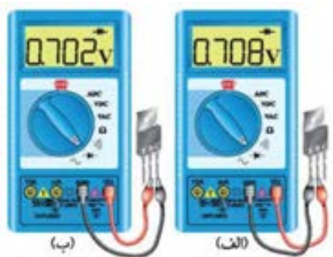
شکل ۴-۴- ولتاژ موافق کلکتور-بیس و امیتر-بیس
