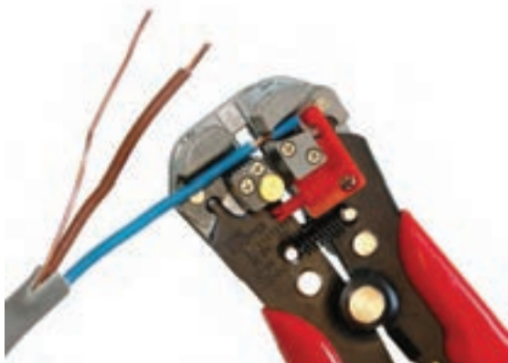
شکل ۲۱-۱- روکش‌برداری با سیم لخت کن خودکار
