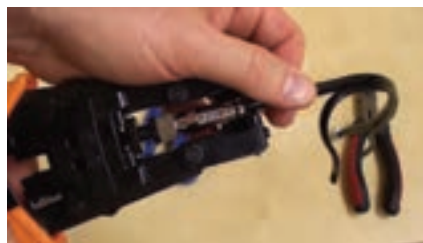
شکل ۱-۷۲ - دو نمونه دستگاه پرچ BNC
