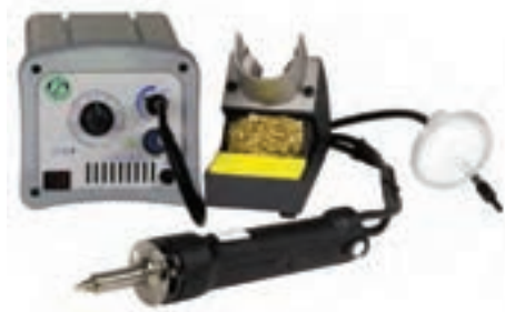
شکل ۸۸-۱- قلع کش حرارتی با پمپ مکش برقی
