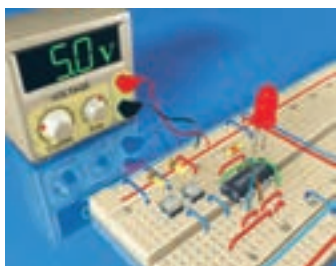
شکل ۷-۴- بستن مدار روی بردبرد و آزمایش آن
