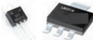
شکل ۳-۸۱- نقشه مدار و تصویر دو نمونه رگولاتور منفی
