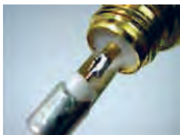
شکل ۱-۷۰- اتصال کابل کوآکسیال به فیش آنتن
