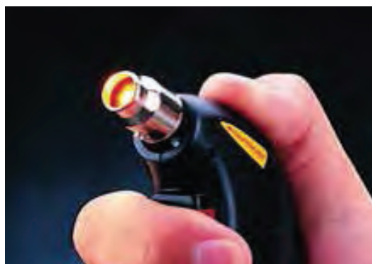
شکل ۶۱-۱- دستگاه گرم کن برای وارنیش حرارتی
