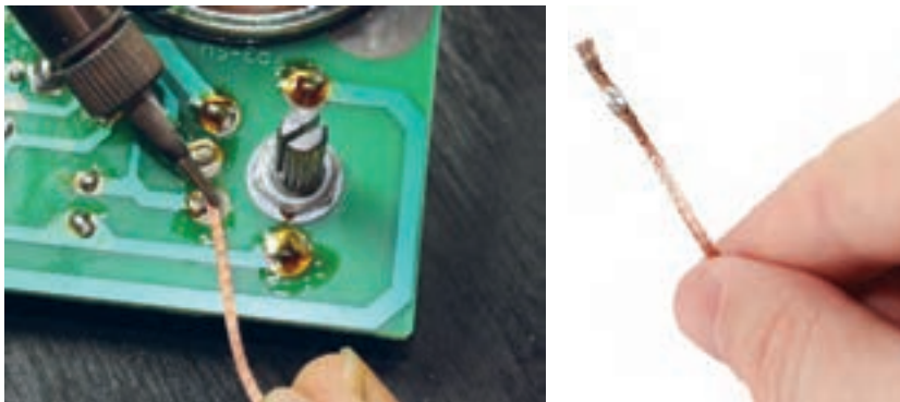
شکل ۸۰-۱- برداشتن قلع از روی فیبر
