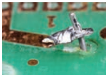
شکل ۹۲-۱- (اینفو گرافیک) نمونه‌هایی از لحیم مشکل دار
