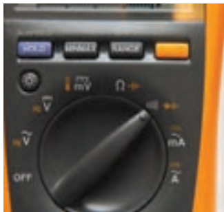
شکل ۳-۵- مولتی متر دیجیتالی در حالت آزمایش دیود
