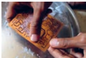
شکل ۱۱-۷- جدا کردن کاغذ از سطح روی فیبر
