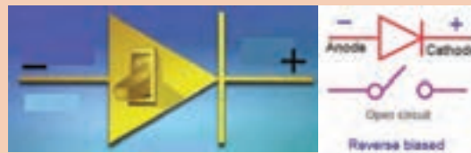
شکل ب ۳-۸- دیود ایده‌آل در بایاس مخالف
