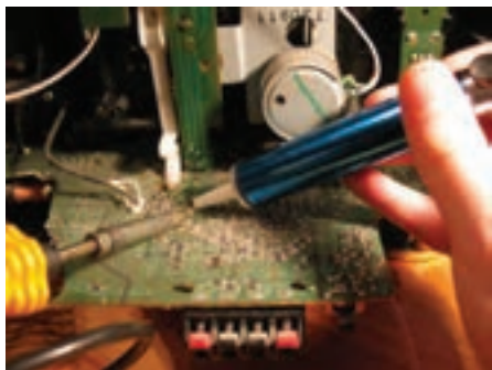
شکل ۸۴-۱- مراحل ذوب شدن و مکش قلع
