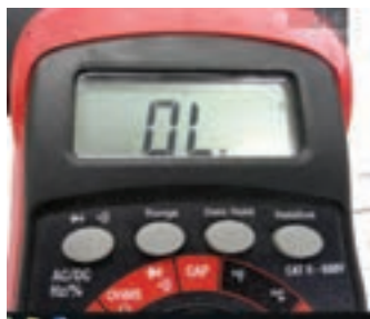
شکل ۳-۶- وضعیت تست دیود در بایاس موافق
