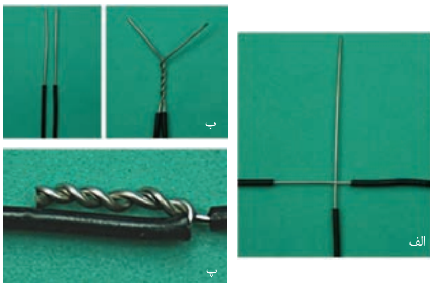
شکل ۴۸-۱- مراحل قلع اندود کردن سیم مسی
