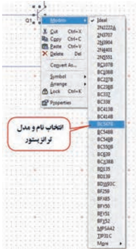
شکل ۱۹-۶- نحوه انتخاب نام و مدل ترانزیستور
