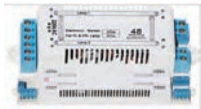
شکل ۵۶-۲- ساختمان ظاهری بالاست الکترونیکی
