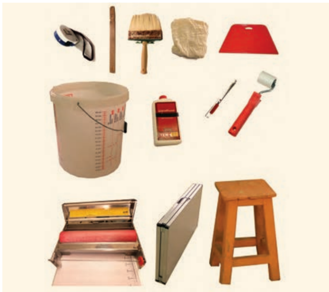
شکل ۶۲-۳- ابزار و تجهیزات کارگاه اجرای کاغذ دیواری
