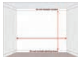
۱- اندازه‌گیری محدوده دیوار برای رنگ‌آمیزی شکل ۲۰-۵
