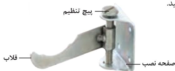
بست قابل تنظیم رادیاتور
