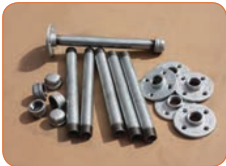
فلز روی در روکش لوله گالوانیزه
