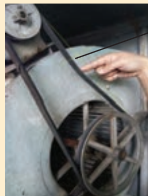
آزمایش سفتی تسمه
