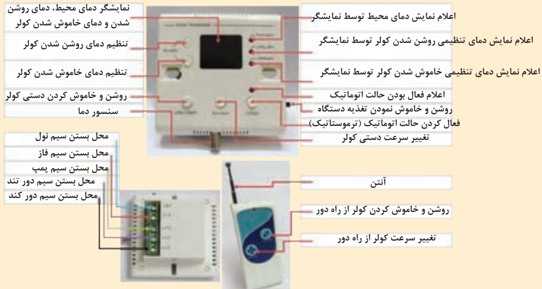
مدار کلید هوشمند کولر آبی
