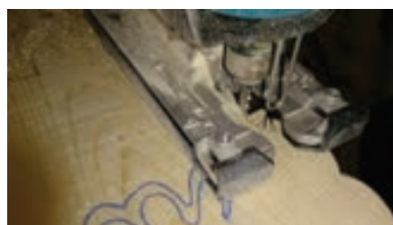
شکل ۱۶- انتقال طرح شابلون روی چوب
