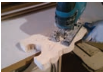
شکل ۱۹- قرارگیری تیغه داخل سوراخ مته
