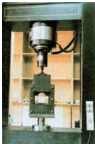
شکل ۵-۳۷- طرز قرار گرفتن نمونه چوب در دستگاه آزمایش
