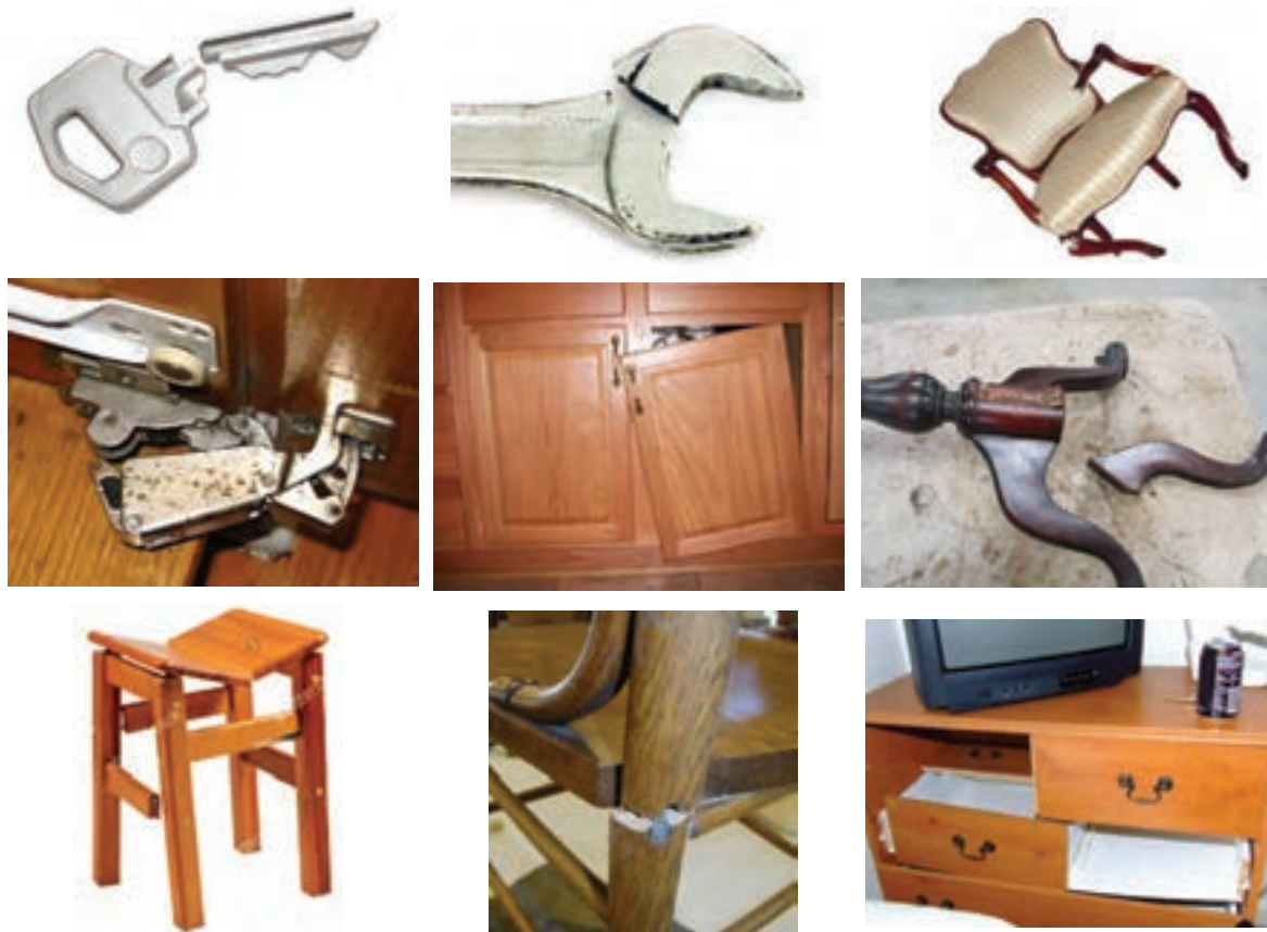
شکل ۵-۵- خرابی و شکست قطعات
