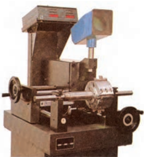
شکل ۴-۱۵- دستگاه تنظیم تیغه رنده
