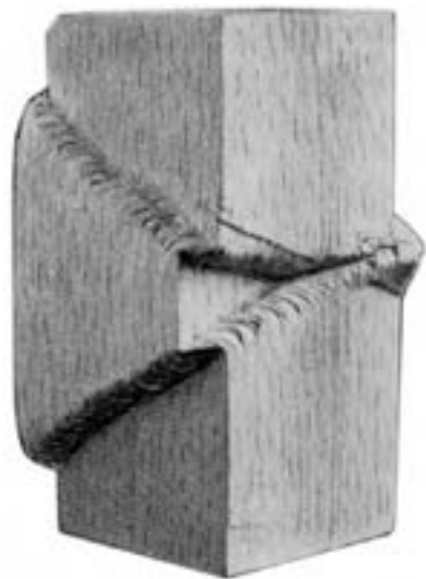
شکل ۳۴-۵- شکست چوب در اثر نیروهای فشاری
