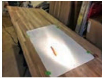
شکل ۹۹ - نصب شابلون برشی روی صفحه کابینت و خط کشی طرح برش
