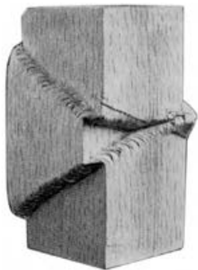
شکل ۳۴-۵- شکست چوب در اثر نیروهای فشاری
