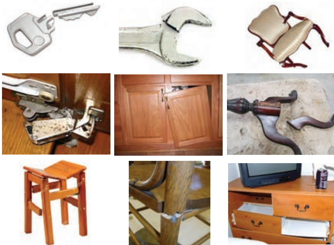
شکل ۵-۵- خرابی و شکست قطعات
