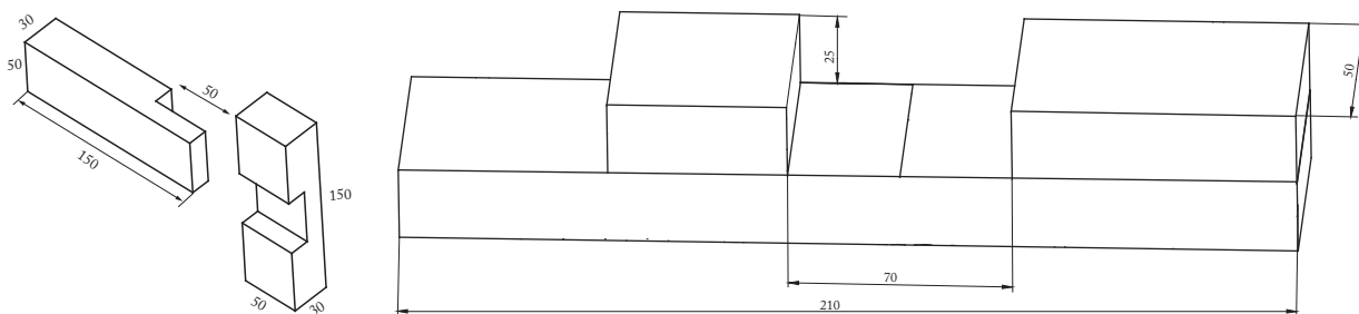
شکل ۹- الف - قطعه کار تمرین مهارت برای برش اتصال نیم و نیم T شکل
