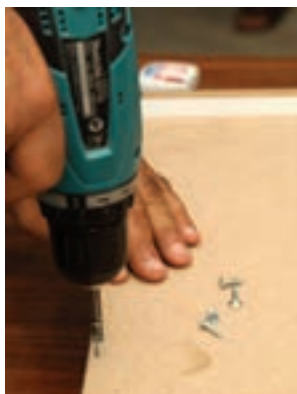
شکل ۵۶ - بستن کف جعبه با پیچ
