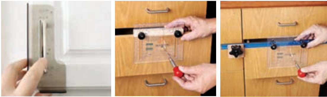
شکل ۱۳۵- چند نوع شابلون سوراخ کاری محل دستگیره
