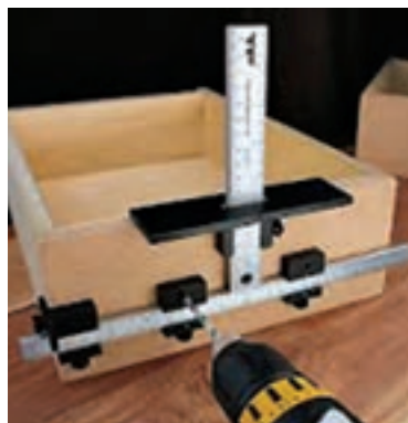
شکل ۱۳۴- چند نوع شابلون سوراخ کاری محل دستگیره
