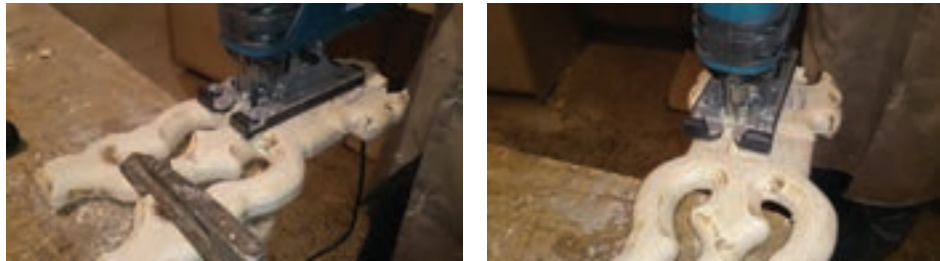
شکل ۲۶- برش طولی مفصل با اره عمودبر
