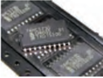
تصویر ظاهری انواع پکیج های SOIC
