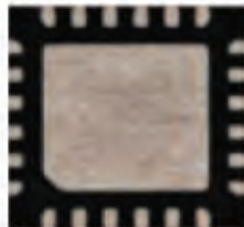
تصویر ظاهری انواع پکیج های DFN, DFNT
