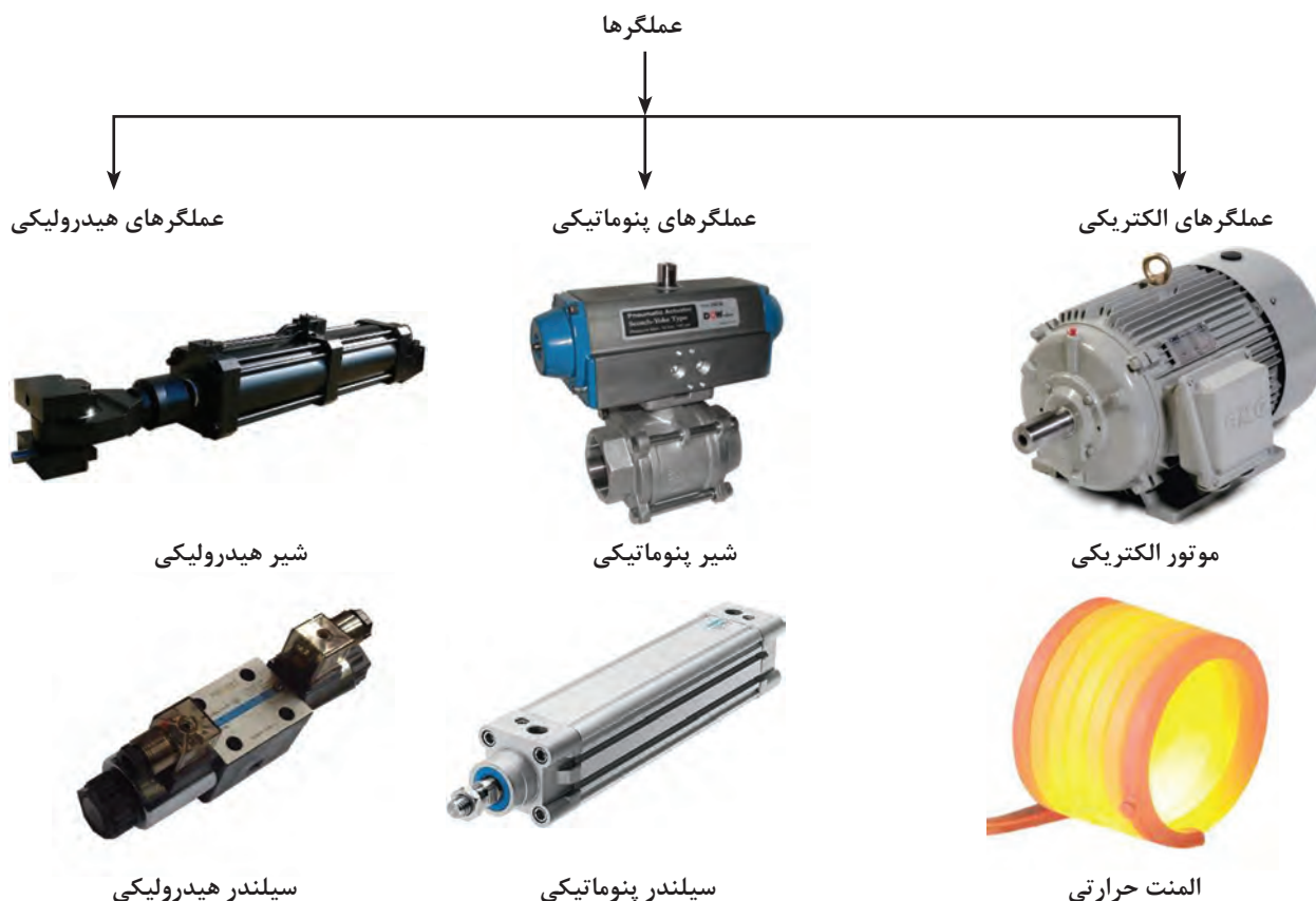
شکل ۲۶-۵- انواع محرک‌ها در سیستم‌های کنترلی
