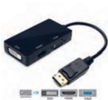
شکل ۵- مبدل Display Port
