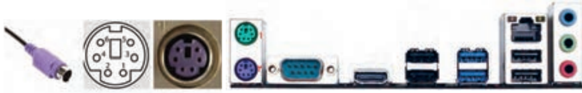
شکل ۸- درگاه‌های روی برد اصلی
