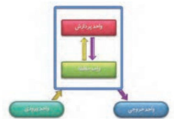
شکل ۱- نمودار سخت‌افزاری سیستم رایانه‌ای
