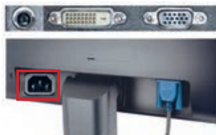
شکل ۴- محل اتصال کابل‌های صفحه نمایش
