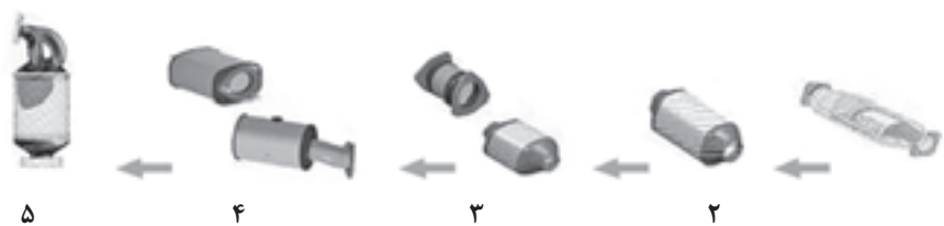
شکل ۱۲-۳ سیر تکاملی مبدل‌های کاتالیستی
