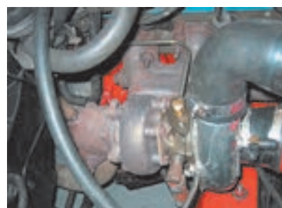
محل نصب توربو شارژر روی موتور
