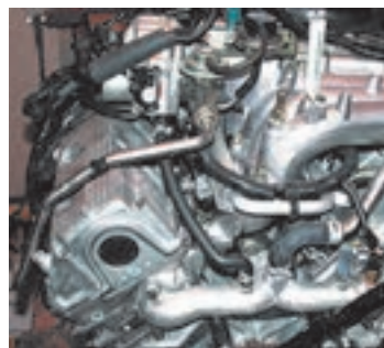
محل نصب EGR روی موتور خودرو
