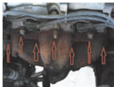
تصویر نشتی بین مانیفولد و لوله اگزوز
