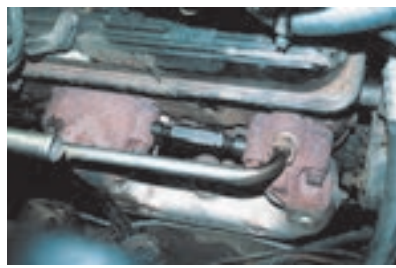
تصویر نشتی دود بین مانیفولد و سرسیلندر
