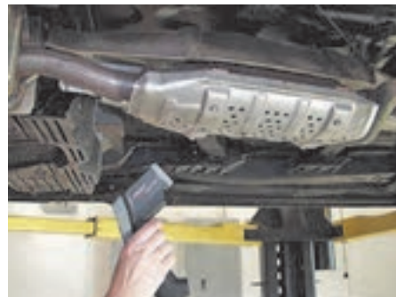
برای کنترل دمای کاتالیزور با استفاده از حرارت‌سنج آن، خودرو باید روی جک بالا بر، روشن و به دمای نرمال رسیده باشد.
