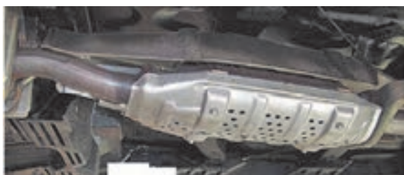
شکل ۲۷-۳ محل نصب سپر حرارتی در سیستم اگزوز
