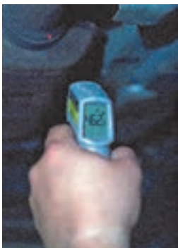
دمای خوانده شده کاتالیزور پس از گرم شدن موتور
