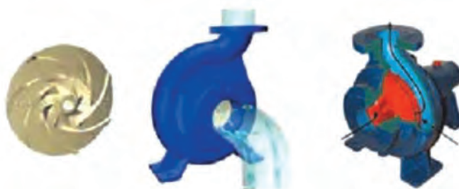
شکل ۱۰- مسیر جریان مایع در پمپ گریز از مرکز
