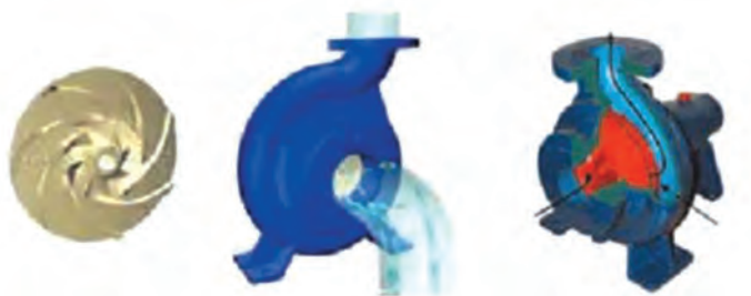
شکل ۱۰- مسیر جریان مایع در پمپ گریز از مرکز
