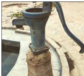
شکل ۲- تلمبه آب (سیلندر پیستونی قدیمی)
