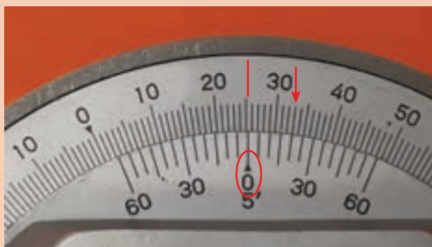
شکل ۱۱- اندازه‌گیری با زاویه‌سنج
